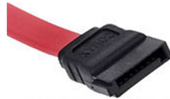
SATA konektor na základní desce a kabelu
