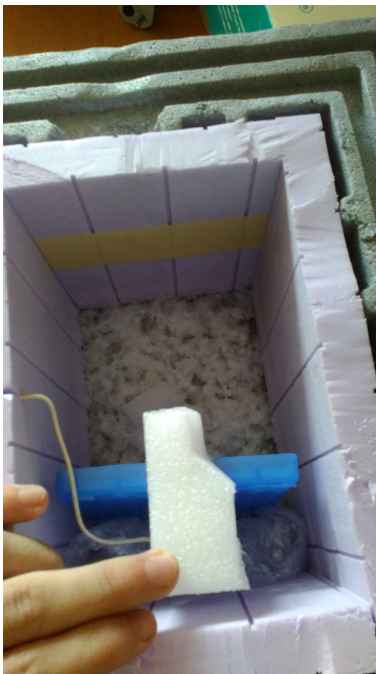
Obrázek 8: Termobox s přidanou vnitřní izolací po 19 hodinách
