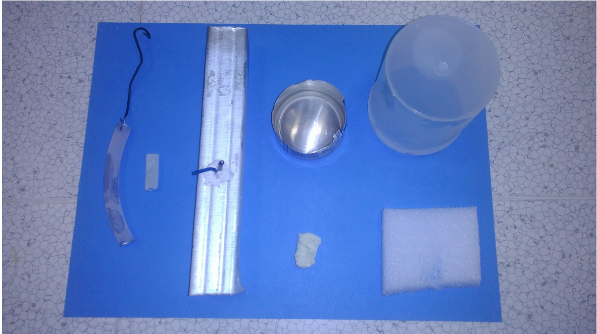
Obrázek 10: Test odolnosti vůči dusíku - průhledná silikonová hadička 2x, klasický spárovací silikon, plechovka (hliník), plastová nádoba (z tvrděného polyethylenu), PUR pěna (zakoupena ve spreji, typ PU Patex Universal), pěnová porézní polyesterová hmota
