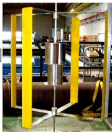
Obrázek 7: Kombinace Savoniova rotoru a Darrieova rotoru.
